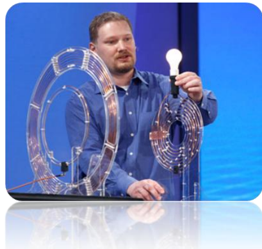
Рис. 2 Директор корпорації Intel із технологій Джастін Раттнер демонструє безпроводову передачу енергії)
